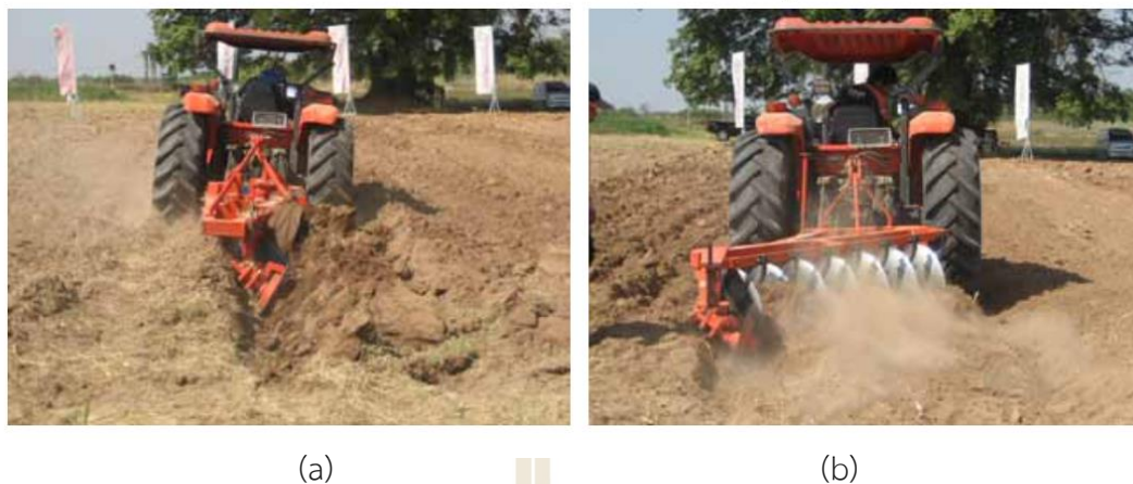
รูปที่ 2.4 (a) การไถด้วยพาล 3 และ (b) พรวนด้วยพาล 7
