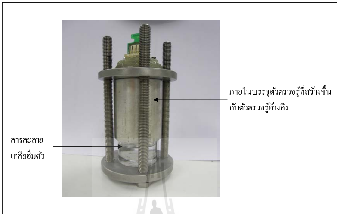
รูปที่ 5.7 ชุดปรับเทียบมาตรฐานของตัวตรวจรู้ด้วยสารละลายเกลืออิ่มตัว
