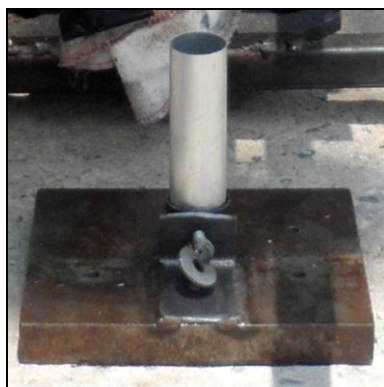
รูปที่ 3.12 การติดตั้งชิ้นทดสอบเข้ากับแท่นยึดตรึง
