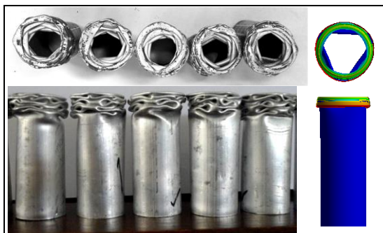
รูปที่ 4.1 เปรียบเทียบรูปร่างการเสียรูปขึ้นทดสอบการชนกระแทกโครงสร้างผนังบาง
