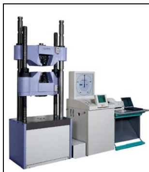
รูปที่ 3.5 เครื่องทดสอบเอนกประสงค์ Shimadzu UH-2000 k
