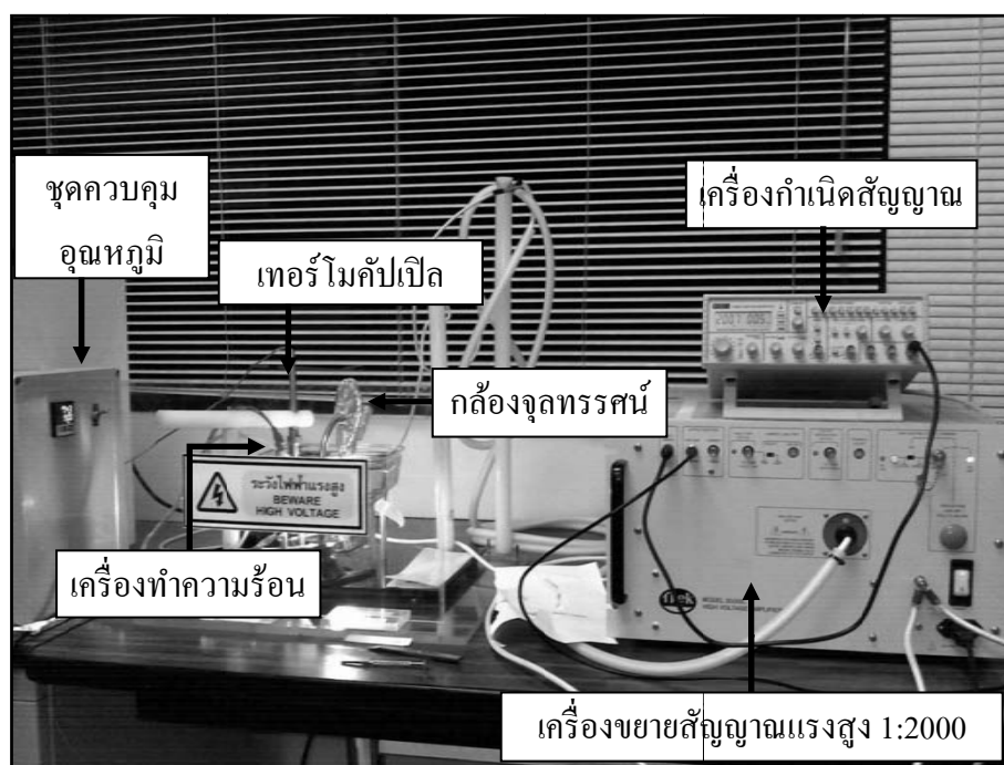
รูปที่ 5.11 ชุดศึกษาวิจัยทริอิงทางไฟฟ้าในสายเคเบิลฉนวน XLPE
