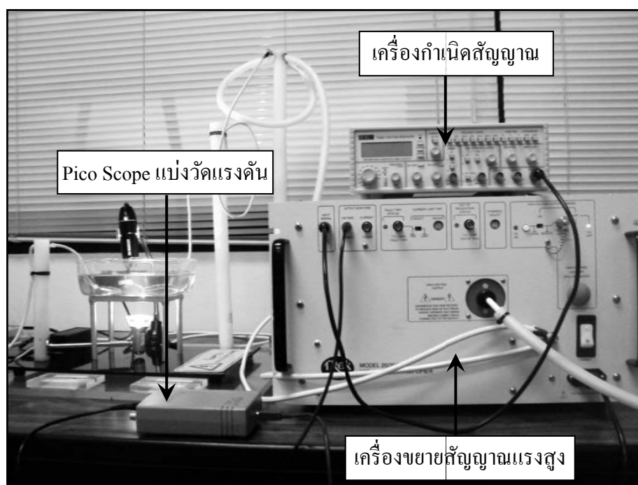
รูปที่ 5.10 ระบบกำเนิดสัญญาณและขยายสัญญาณแรงดันสูงที่ใช้ในการวิจัย
