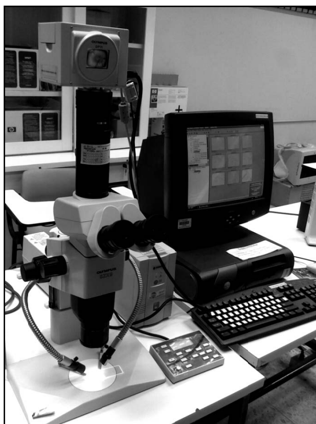
รูปที่ 5.9 กล้องจุลทรรศน์ที่ใช้ในงานวิจัยขนาด 570X (OLYMPUS SZX9)
