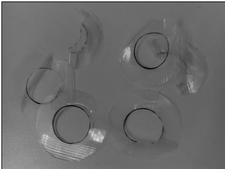
รูปที่ 6.51 ชิ้นงานที่ผ่านการตัดด้วยเครื่องตัดไมโครโทม
