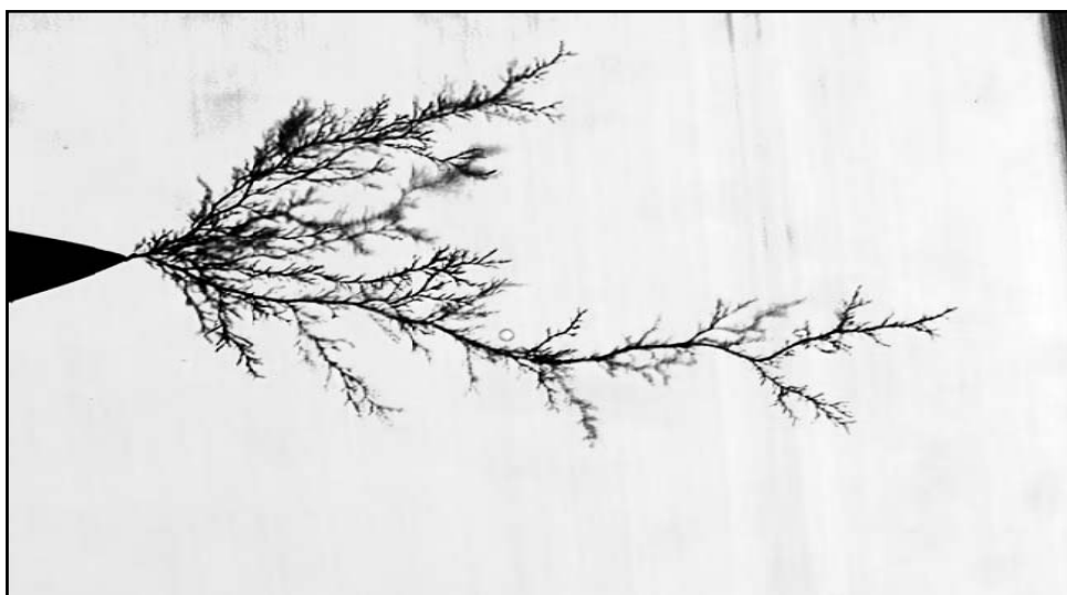
รูปที่ 3.17 ทรีอิงทางไฟฟ้าในเนื้อฉนวน (ที่มา: http://www2.le.ac.uk/departments/engineering/research/electrical-power/images/Electrical%20Tree.jpg )
