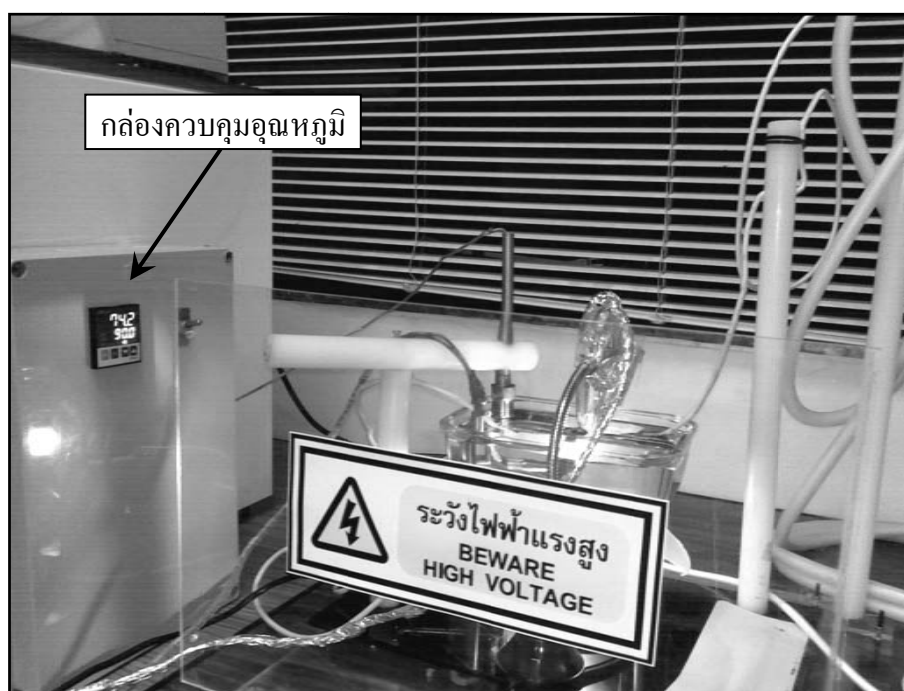
รูปที่ 5.7 ชุดทดสอบทริอิงทางไฟฟ้าและกล่องควบคุมอุณหภูมิ
