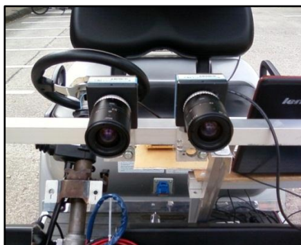
รูปที่ 2.1 การติดตั้งกล้องสองตัวแบบขนาน
