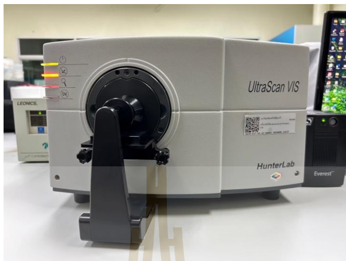
รูปที่ 3.33 เครื่องวัดสี ยี่ห้อ HunterLab รุ่น UltraScan VIS
