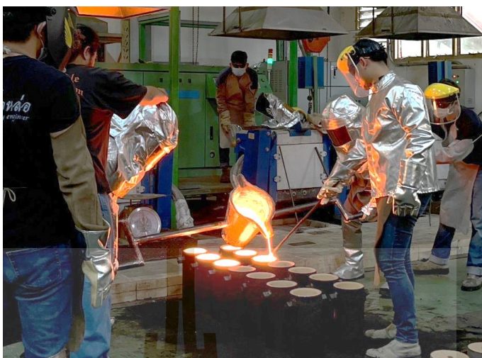
รูปที่ 3.7 การเทน้ำโลหะหลอมเหลวลงแบบหล่อทราย CO 2
