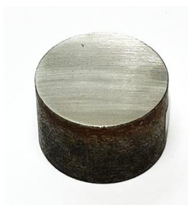
รูปที่ 3.24 ชิ้นงานตัวอย่างสำหรับวัดความแข็ง
