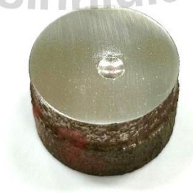
รูปที่ 3.26 รอยกดด้วยเครื่องวัดความแข็งแบบบริเนล
