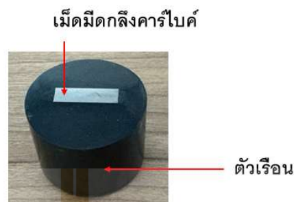
รูปที่ 3.20 การขึ้นตัวเรือนเม็ดมีดกลึง
