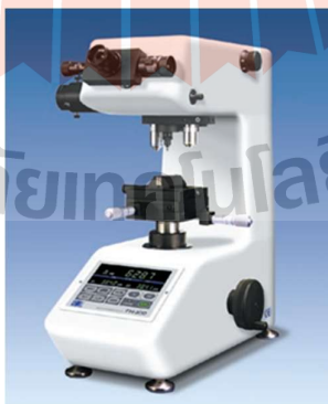
รูปที่ 3.7 เครื่องทดสอบความแข็งแบบวิกเกอร์
