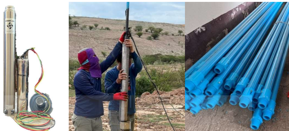
รูปที่ 3.3 ชุดปั๊มสูบน้ำแบบจุ่มลงบ่อลึก (Submersible Pump)
