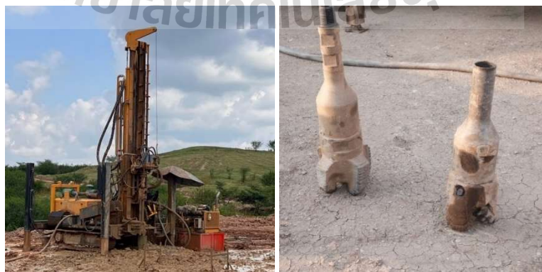
รูปที่ 3.2 รถขุดเจาะบ่อน้ำบาดาลแบบดินตะขาบ
