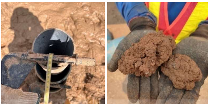
รูปที่ 3.11 ตรวจสอบความลึกของระดับน้ำ พร้อมเก็บเศษตัวอย่าง ในระหว่างดำเนินการขุดเจาะ
