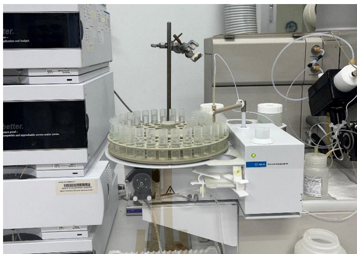
รูปที่ 3.9 เครื่องวิเคราะห์ปริมาณแร่ธาตุในระดับความเข้มข้นต่ำ (ICP-MS)
