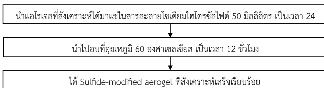
รูปที่ 3.5 การสังเคราะห์แอโรเจลที่ปรับปรุงด้วยซัลไฟด์
