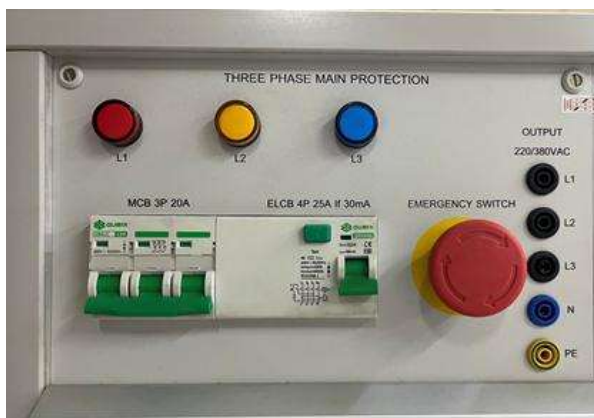
รูปที่ 8.2 แหล่งจ่ายไฟฟ้ากำลังสามเฟสแบบคงค่าได้
