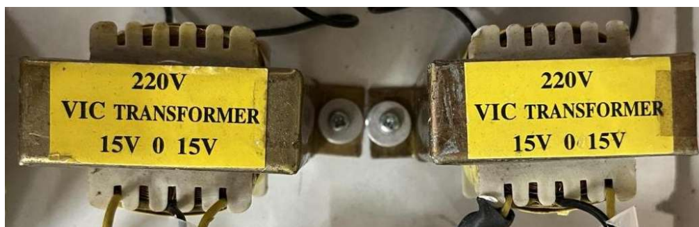
รูปที่ 8.14 หม้อแปลงแท่งกลางสำหรับตรวจวัดแรงดันไฟฟ้า
