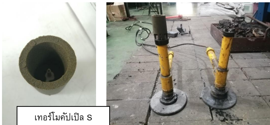
รูปที่ 3.14 อุปกรณ์สำหรับการวัดอัตราการเย็นตัวของเหล็กหล่อเหนียว
