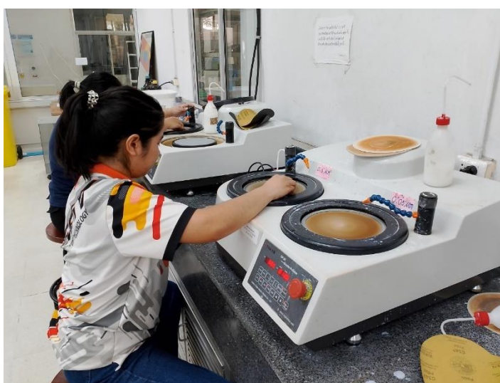
รูปที่ 3.26 ขั้นตอนการขัดด้วยผ้าสักหลาดโดยใช้ผงอะลูมินา
