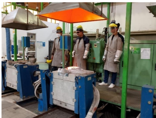
รูปที่ 3.4 เตาหลอมและตู้ควบคุม
