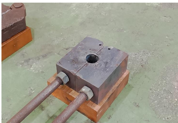
รูปที่ 3.10 แม่พิมพ์ทองแดงสำหรับรองรับการชักตัวอย่างน้ำโลหะ
