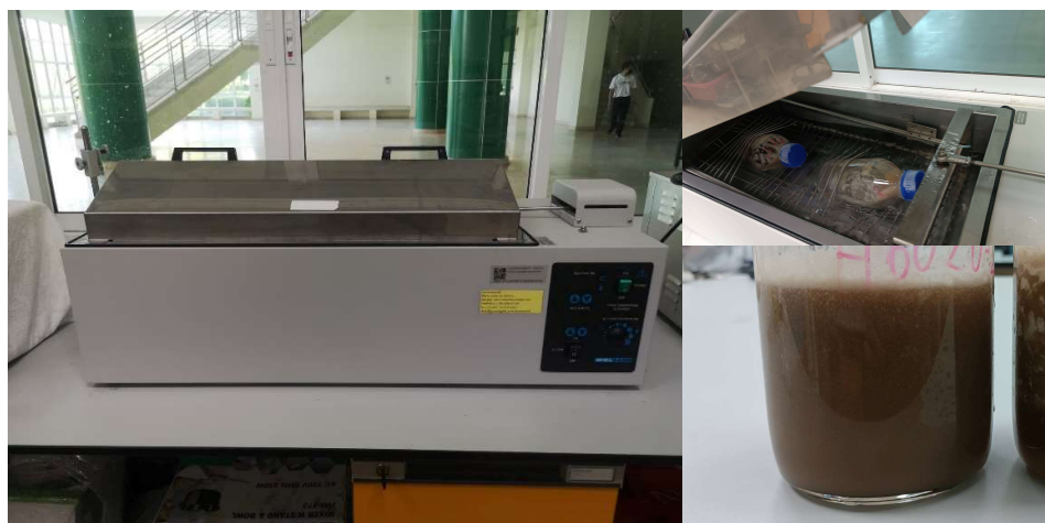
รูปที่ 3.6 ภาพการดำเนินการสกัดสารอินูลินด้วยอ่างน้ำควบคุมอุณหภูมิ
