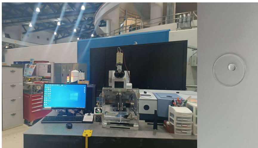
รูปที่ 3.17 การวิเคราะห์โครงสร้างทางเคมีของผงสารสกัดอินนูลินด้วย SR-FTIR
