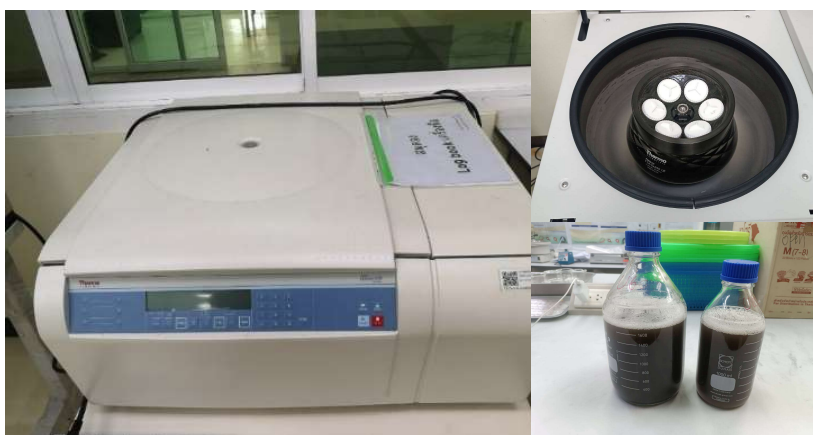
รูปที่ 3.8 ภาพการดำเนินการแยกสารสกัดอินนูลินออกจากกาก (Residue) ด้วยเครื่องปั่นเหวี่ยง
