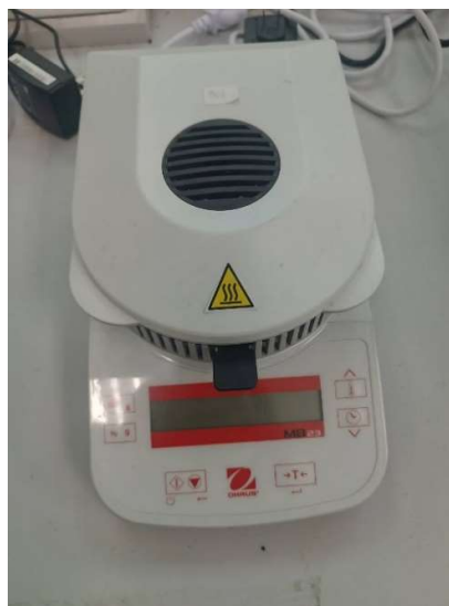
รูปที่ 3.13 เครื่องวิเคราะห์ปริมาณความชื้นของผงอินนูลิน
