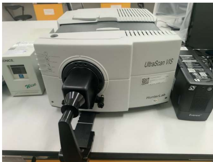
รูปที่ 3.23 การวิเคราะห์ค่าสีด้วยเครื่องวัดสี
