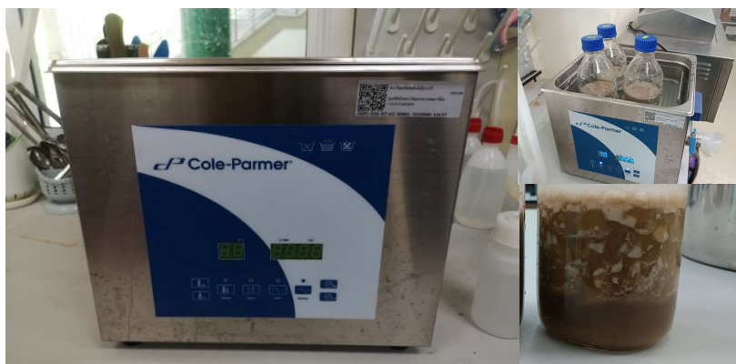
รูปที่ 3.7 ภาพการดำเนินการสกัดสารอินนูลินด้วยเครื่องคลื่นเสียงความถี่สูง
