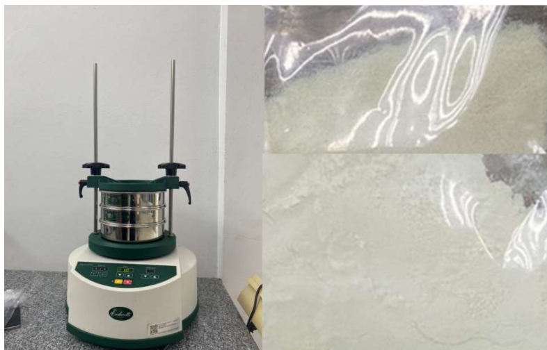
รูปที่ 3.4 ภาพการดำเนินการร่อนแยกขนาดด้วยเครื่องร่อนและตะแกรกร่อน
