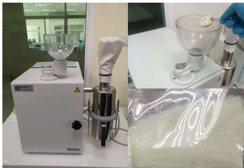
รูปที่ 3.3 ภาพการดำเนินการบดหัวแค้นตะวันแห้งด้วยเครื่องบดละเอียดแบบหัวค้อน
