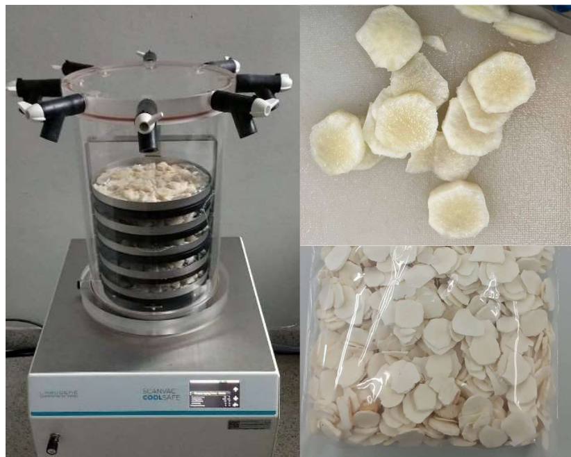
รูปที่ 3.2 ภาพการดำเนินการทำแห้งหัวแค้นตะวันด้วยเครื่องทำแห้งแบบแช่เยือกแข็ง
