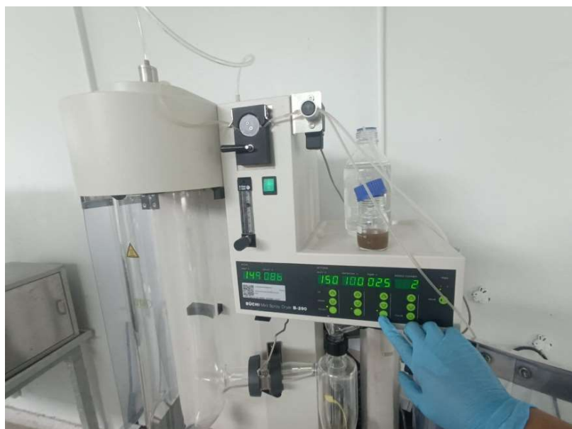
รูปที่ 3.11 การทำแห้งแบบพ่นฝอยสารสกัดอินนูลิน
